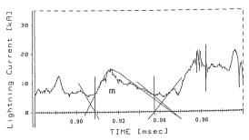
図6 雷放電電流の等価素波形の例 (11.7/27.7 µs, 14.88kA)
