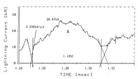
図5 雷放電電流素波形の例(成長期)
