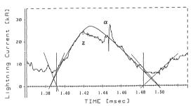
図7 雷放電電流の等価素波形の例 (43.4/83.0 us, 26.98kA)
