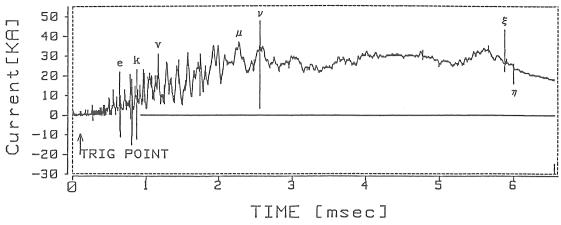
図1 正極性雷放電電流波形(35kA級)
