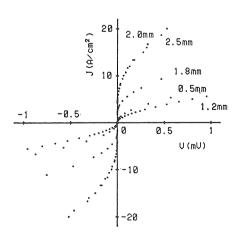
図7。ブリッジ幅をパラメータとした 電流密度-電圧特性 (焼結温度 940℃,測定温度 70K)
