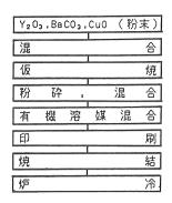
図1. 超伝導厚膜の作製工程図
