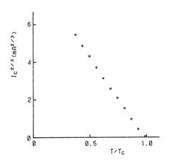
図 6。 臨界電流の温度特性 (焼結温度 940℃, ブリッジ幅 1.8mm)
