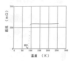
図4。膜の電気抵抗-温度特性
