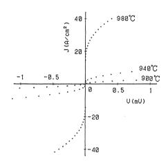
図8. 焼結温度をパラメータとした 電流密度-電圧特性 (ブリッジ幅 2.0mm, 測定温度 70K)
