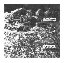
図3。膜断面のSEM写真
