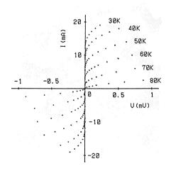
図5。 測定温度をパラメータとした 電流 - 電圧特性 (焼結温度 940℃, ブリッジ幅 1.8mm)
