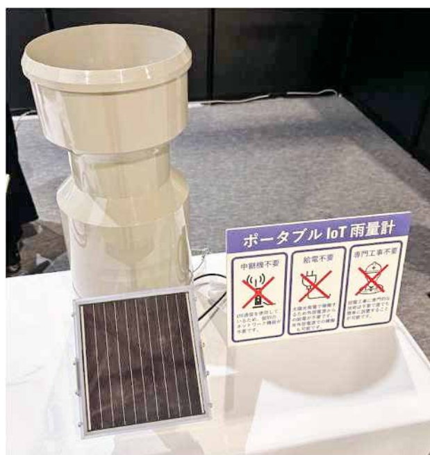
写真3 雨量計本体とのアッセンブリー
