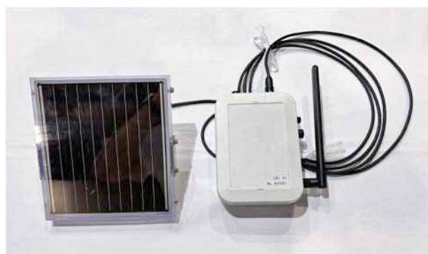
写真2 開発した太陽光稼働型雨量データ通信ユニット
