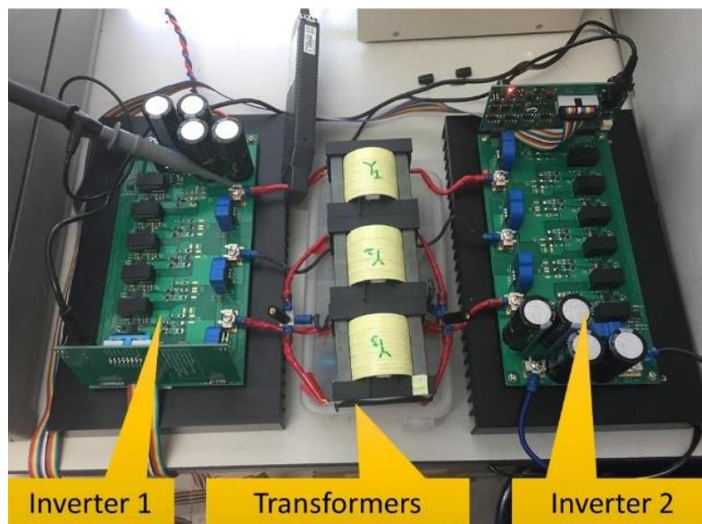
図 4-7 10-kW DAB コンバータ実験システム
