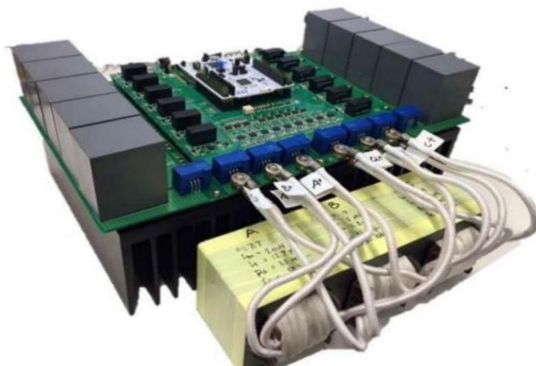
図 5-15 プロトタイプ DAB コンバータ[4]
