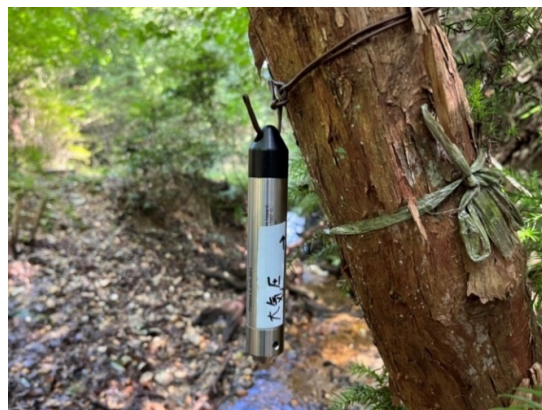
写真-9 HOBO U20 水位ロガ-(U20-001-04)大気圧
