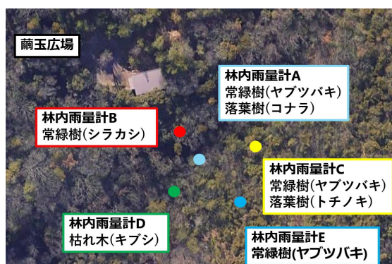
写真-6 A～E 地点の転倒マス雨量計設置個所と雨量計直上の林冠構造
