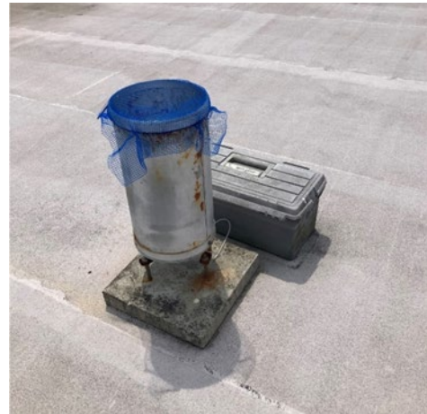
写真-2 林外雨量計(0.5mm 転倒マス雨量計)
