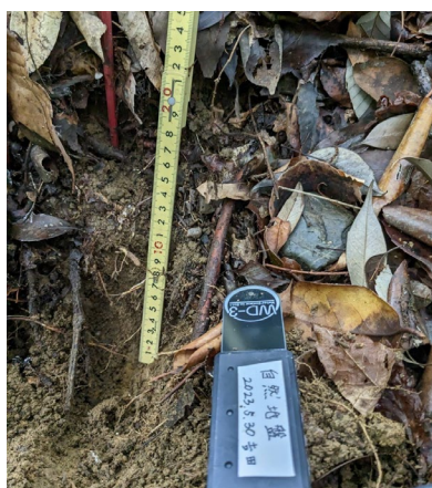
写真-7 土壌水分計(自然地盤 10cm)
