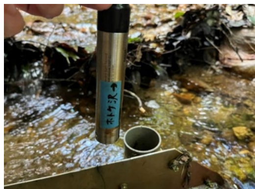
写真-8 HOBO U20 水位ロガ-(U20-001-04)絶対圧力
