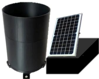
写真 3 開発した低コスト雨量計および観測システム
