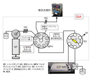
図1 尿中バナジウム(V)とクレアチニン(CR)の逐次定量分析システム. 販のキレート樹脂が担持された吸着剤を予め充填して おく。まず MPV のポート1 から酢酸アンモニウム溶液 を C に通液してコンディショニングを行う。次にポー ト2から V標準液(あるいは酸分解尿試料)を Cに通 液する。このとき尿試料中に存在する高濃度のNa+、Ca<sup>2+</sup>、 Cl-などからなる塩類は C の吸着剤には吸着されない。 つまり脱塩が達成される。一方、分析対象物質である V はC内の吸着剤に捕捉される。ここでSVを切り替える と溶離液である HNO3 がペリスタポンプ (PP) から C に送られ、V が溶離され ICP-MS 装置に導入される。次 いでMPVのポート7からピクリン酸の塩基性溶液とポ ート6から CR 標準液(あるいは希釈尿試料)を吸引・ 吐出し、反応コイル(RC)に送りクレアチニン濃度に 比例した赤色化合物の吸光度を吸光光度計で計測する。 このようにして、一体型 SIA システムを用いて V と CR を逐次定量し、V/CR 比を求めることができる。
