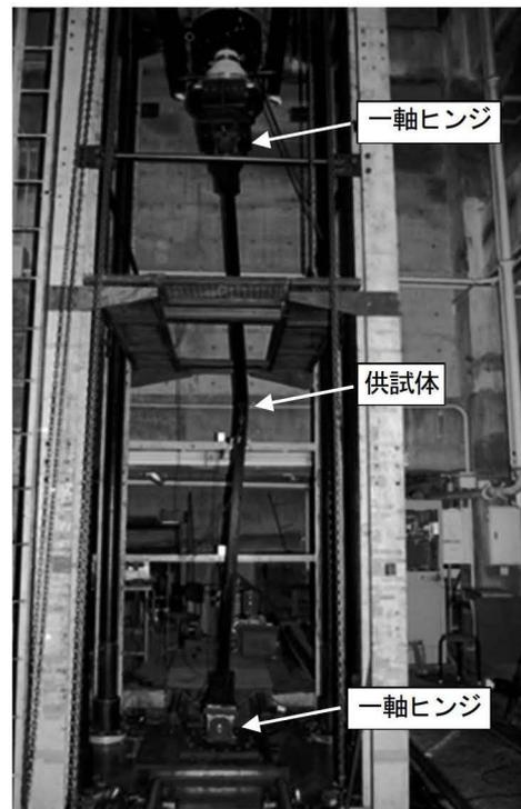
図-2 圧縮耐荷力実験の様子
