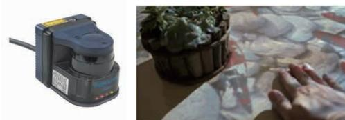
図 2. 測域センサとインタラクション実験例
