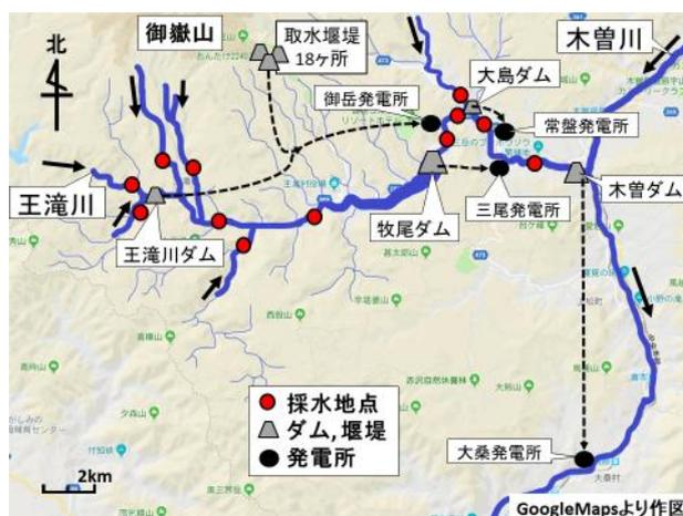
図-4：人工構造物による水路系図
