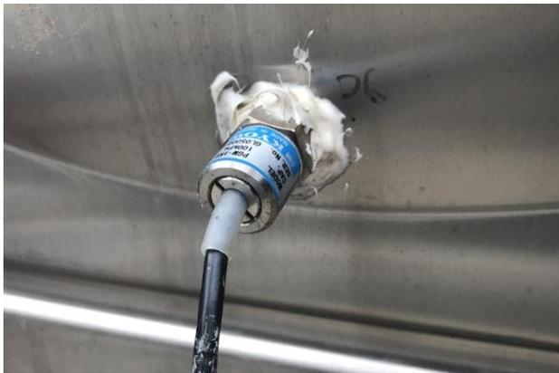
写真-5 側壁水圧計
