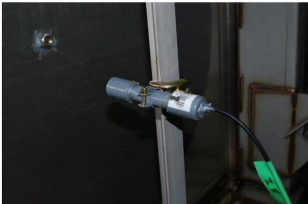
写真-6 タンク内部水圧計
