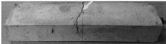
(a) CT引抜き破壊(推定)
