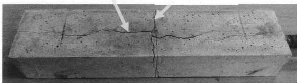
(b) 付着割裂破壊
