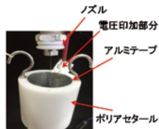
図 4 試作した誘導帯電素子
