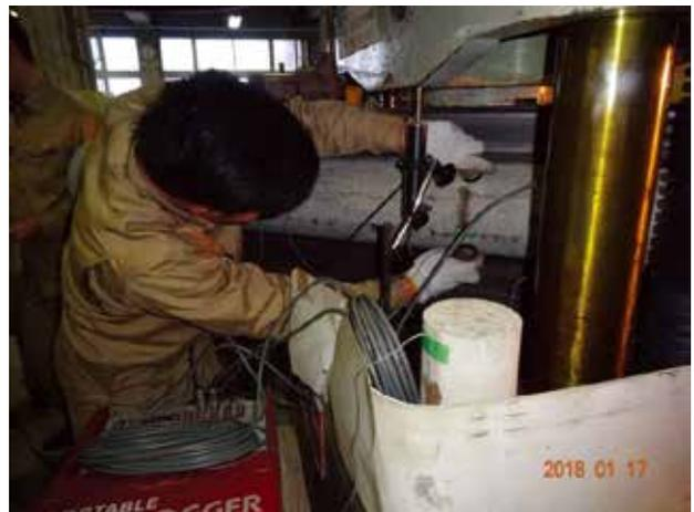
写真-3 荷重中の超音波伝搬速度の測定状況
