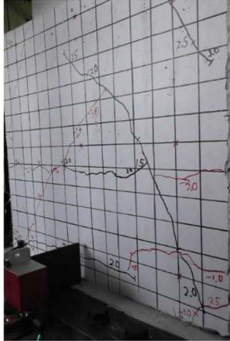
写真-2 根巻きコンクリートの損傷状況
