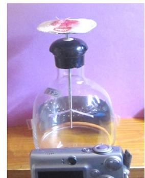
図5 灯芯として使われるマントルに含まれるトリウムからの放射線による箔の開き角の減少
