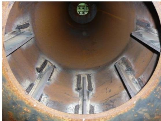
図-3.9 補剛材溶接後の様子 (TH50-8)
