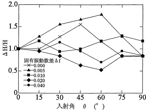
図-16  $\Delta f$  の入射角-最大波高の関係 (H/L=0.094)
