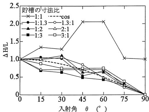
図-11 入射角-正規化した最大波高の関係(水深0.10m)
