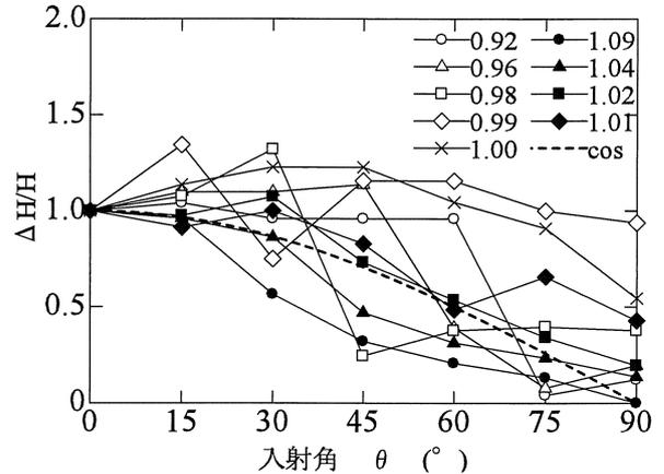
図-15 入射角-正規化した $\Delta H/H$ の関係(H/L=0.20)
