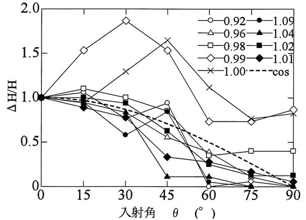
図-14 入射角-正規化した $\Delta H/H$ の関係(H/L=0.094)
