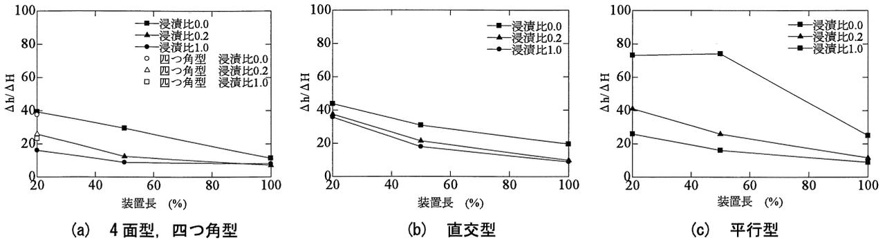
図-20 装置長ごとの最大波高の変化
