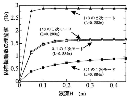
図-4 1:3貯槽における水深-固有振動数の関係
