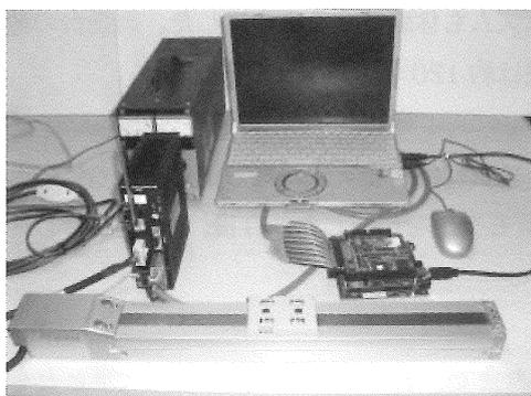
写真 1 震動台全景。最手前のスライダレール上の四角い台 (7 × 7cm) が左右にレール長 40cm。
