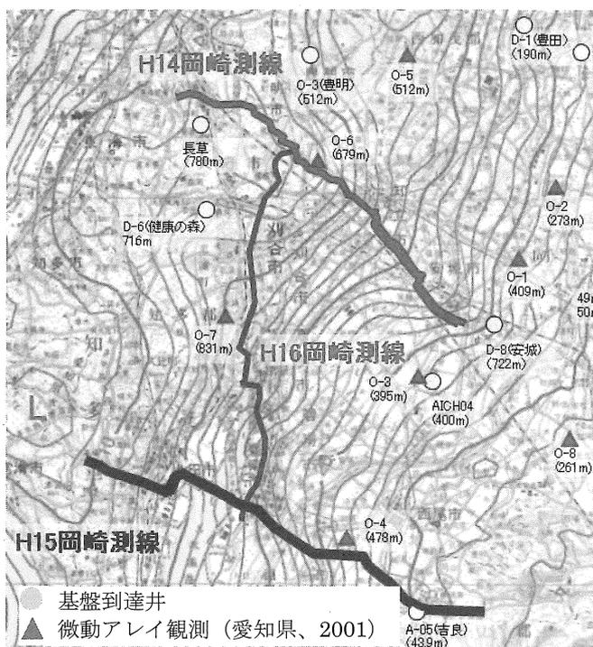
図1 反射法探査測線と微動アレー探査地点 (愛知県、2001)
