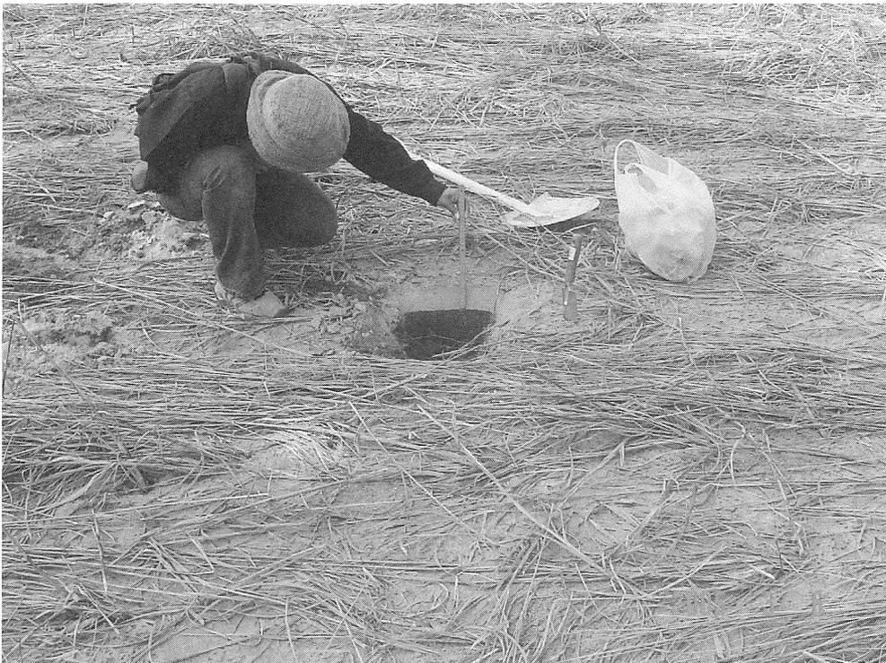
図3 津波堆積物の調査風景。スコップを用いて掘削し、層厚を計測する。周辺では転倒した草の方向から引波の方向もわかる（廣内大助撮影）
