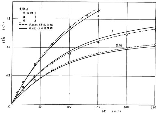
図4 クリープせん断ひずみ  $\delta\gamma_{z\theta}^c$
