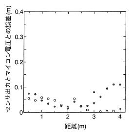
●:実際の距離とセンサ出力の誤差○:センサ出力とマイコン電圧との誤差図 18 1 次元測定における距離ー誤差特性
