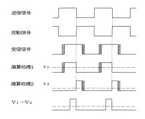
図1 距離-電圧変換方式の原理
