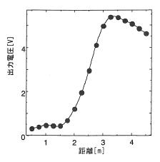
図 4 APC 回路を用いない場合の 1 次元距離測定
