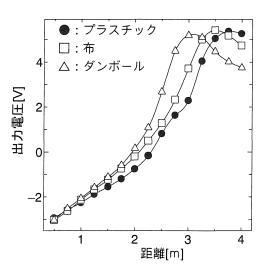
図8 材質別1次元距離測定結果
