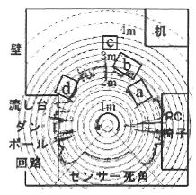
図 11 センサ出力波形と障害物配置図の重ね合わせ
