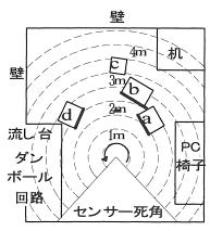
図 12 センサ出力波形と障害物配置図の重ね合わせ
