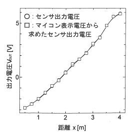
図 17 センサ出力電圧とマイコン表示電圧の比較
