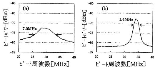
図15 LD<sub>2</sub>のスペクトル線幅の変化
