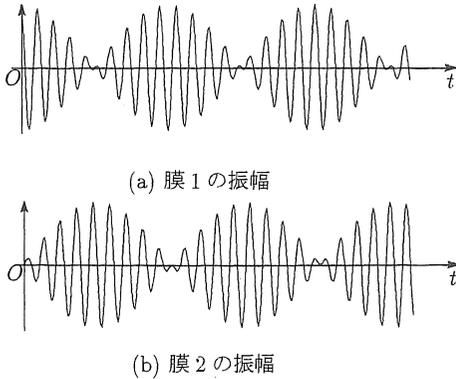
図 5: 太鼓の膜の振動
