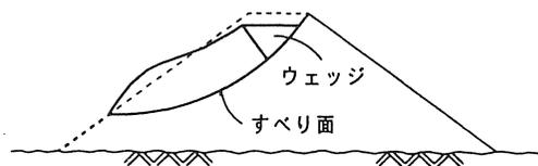
図-11 堅固な地盤上の堤体
